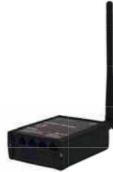
Mit dem **WLAN Modul** ausgestattet bietet Ihnen die Anlage einen WLAN-Hotspot. Es ermöglicht Ihnen somit eine einfache Verbindung zu Ihrer Zentralbatterieanlage ohne zusätzliche Leitungsverlegung. Ideal für den hausinternen Fernzugriff zur Visualisierung oder Wartung. Mit einfachen Schritten können Sie sich per Smartphone, Tablet oder PC auf die Weboberfläche (Webserver) der Anlage einwählen.
