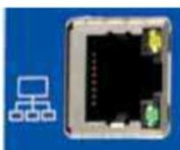
Die in der Steuereinheit integrierte Ethernet Schnittstelle ermöglicht es die Anlage – egal ob my-, micro-, mini-, midi-, multiControl oder MDC komplett per Web-Interface komfortabel zu programmieren und zu überwachen.
