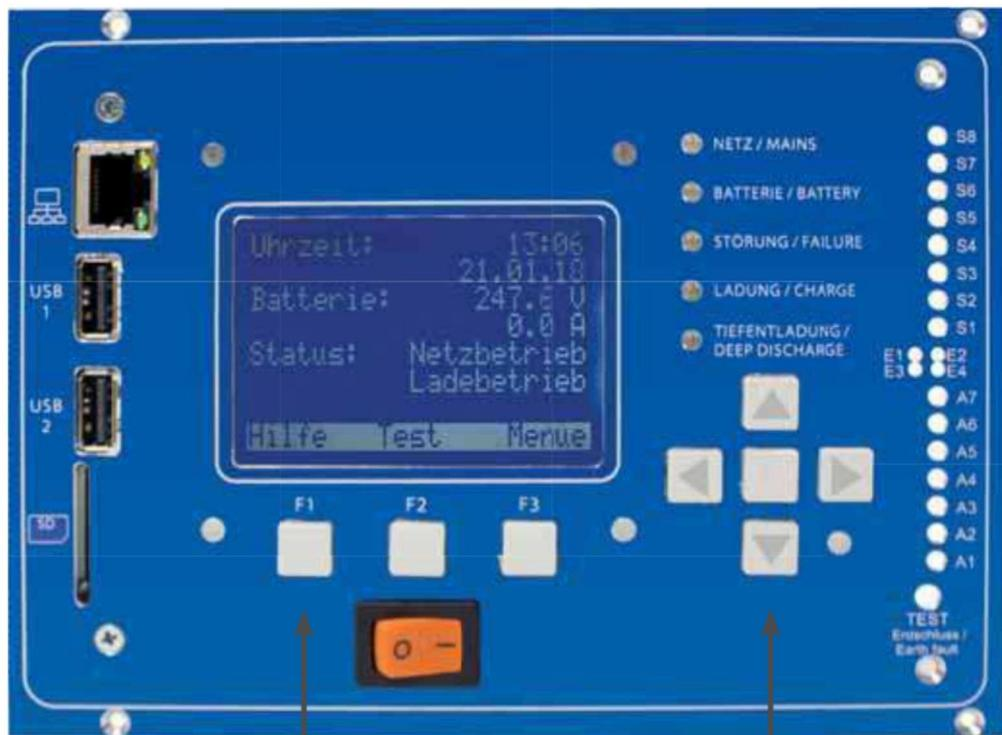
Drei Schnellzugriffstasten direkt unterhalb des Displays werden abwechselnd mit den wichtigsten Befehlen belegt.
