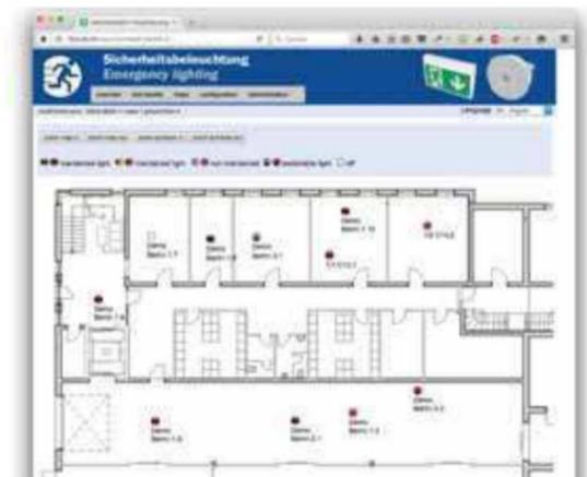
Einzelne Leuchten können per Mausclick auf dem Grundrissplan ausgewählt werden. Die Leuchte wird mit Typenbezeichnung, Betriebsart und dem eingesetzten Leuchtmittel aufgelistet.
