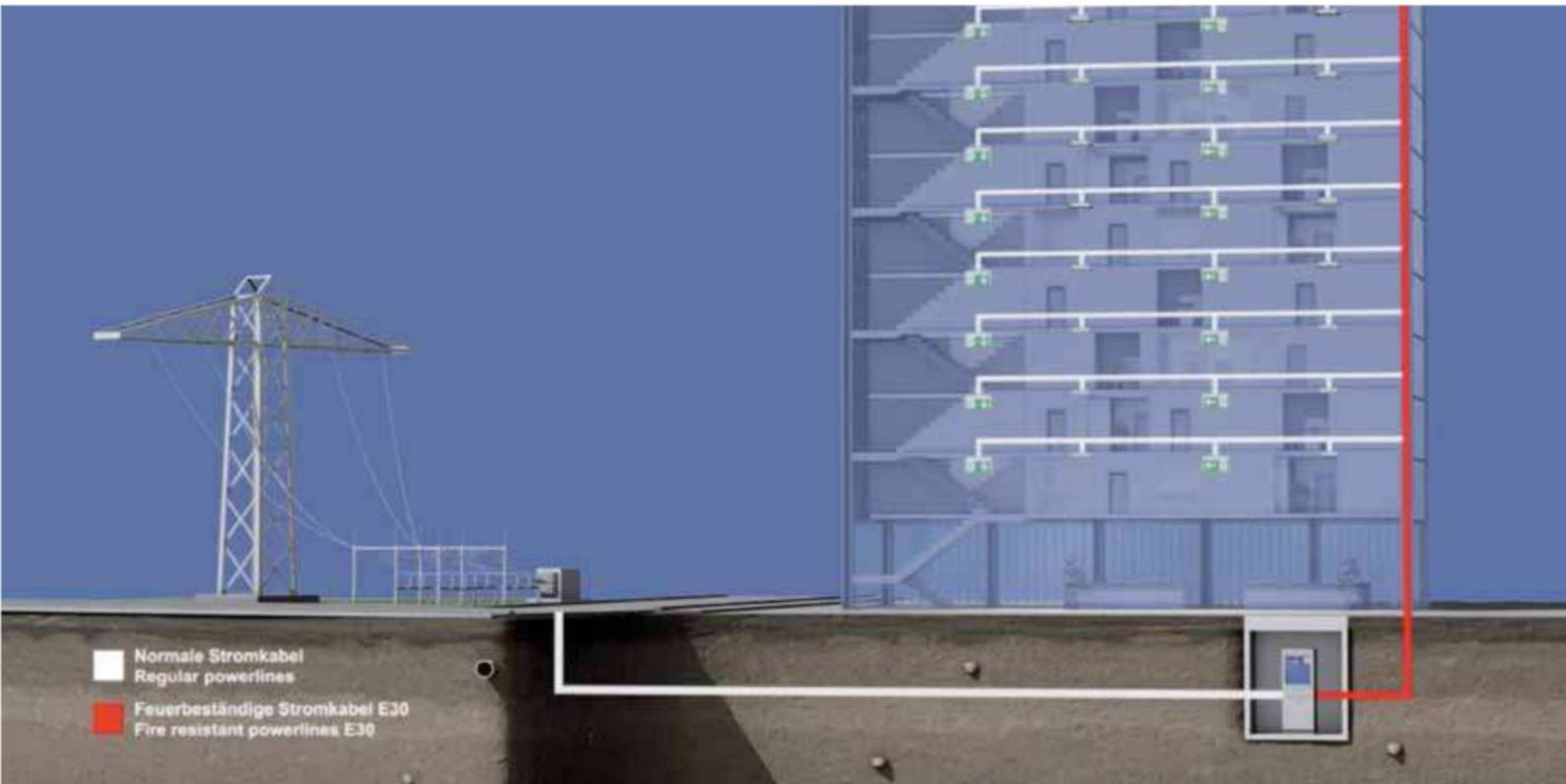
Das Konzept des Zentralbatteriesystems sieht eine Versorgung der angeschlossenen Not- und Sicherheitsleuchten von einem zentralen Punkt aus vor.
