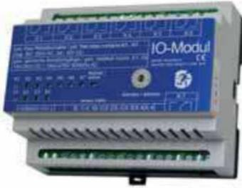
Das **Schalteingangs- und Ausgangsmodul IO** verfügt über 7 Relaisausgänge 230V / 6A mit potentialfreien Wechselkontakten. Das IO-Modul Nr. 1 ist vorprogrammiert für den Anschluss eines konventionellen Meldetab- leaus.
